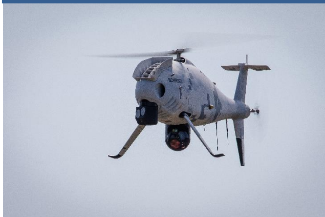
PT-8 OCEANWATCH zamontowany na Camcopter® S-100
