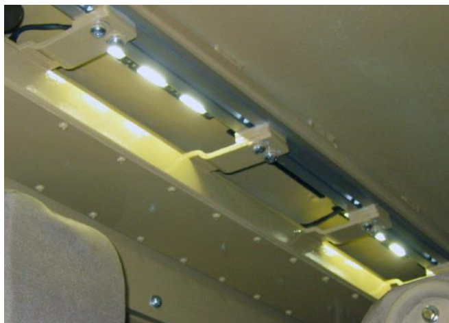
System białych światel rozproszonych mini zamontowanych w kabinie pojazdu wojskowego
